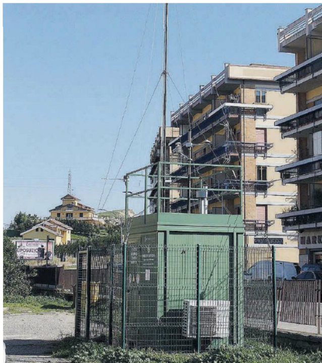
Le verifiche. Una delle tante stazioni automatiche di controllo ambientale installata sul territorio comunale
