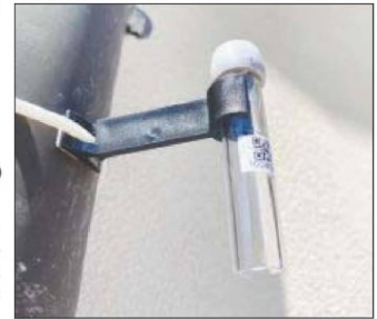
Uno dei rilevatori passivi dei gas di scarico
