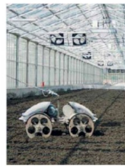
(a.b.) La serra in primo piano il "maiale" usato per la miscelazione dei fanghi
