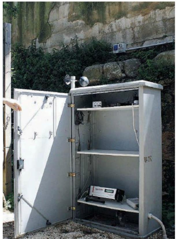
**Una centralina per la misurazione del radon.** Sul territorio verrà creata una rete di strumenti per il controllo della diffusione del gas
